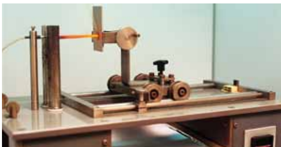
Ensayo del hilo incandescente IEC 61537
