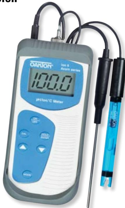
Izquierda: Medidor de Ion 6 Acorn
