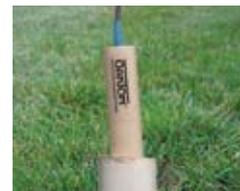
**Arriba:** Las sondas sumergibles caben fácilmente en bocas de pozos de 2".
