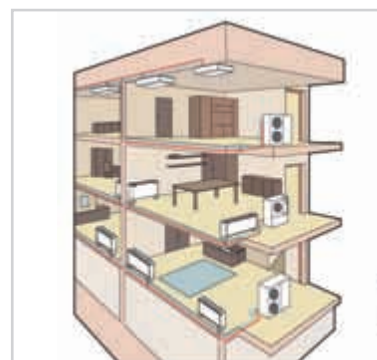
Instalación autónoma para aplicaciones comerciales.
