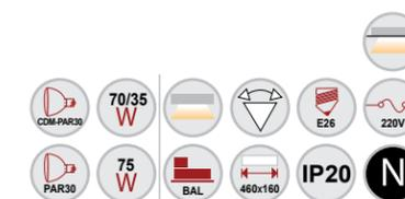
Luminario de empotrar dirigitivo, para lámparas halógenas PAR30 75W ó CDM-PAR30 70W/35W
