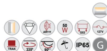
Luminario de sobreponer dirigitble, de exteriores para lámpara halógena AR111 50W
