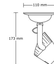
Luminario dirigible de sobreponer en riel o canope, con control óptico para lámpara MR16 50W
