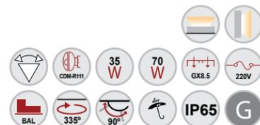
Luminario de sobreponer dirigitble, de exteriores para lámpara CDM-R111 35W ó 70W
