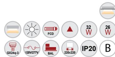
Luminario de empotrar Soflight Pyramid, para lámpara fluorescente compacta doble 2x32W ó 2x26W
