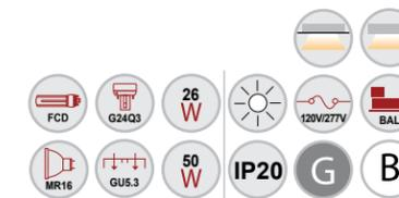
Arbotante de iluminación directa e indirecta, para lámpara fluorescente compacta doble 1x26W y lámpara halógena MR16 50W
