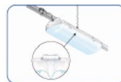
Instalación con grapa metálica
