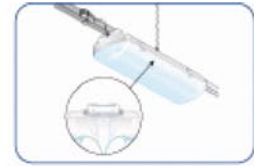
Instalación con grapa metálica
