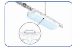
Instalación con grapa metálica
