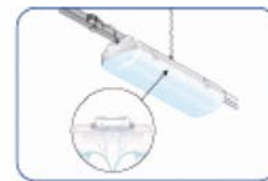
Instalación con grapa metálica
