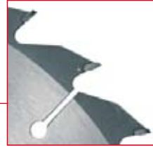
Ranuras de expansión, evitan el calentamiento
